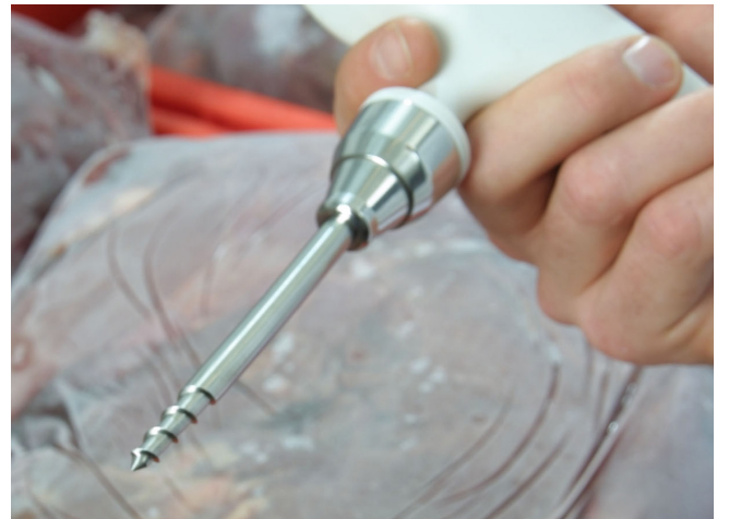
testo 105 ile mal kabulde sıcaklık ölçümü
