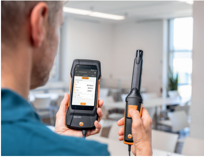
Resim 2: testo 400 iç hava kalitesi ölçüm cihazını kullanarak ortam havasının sıcaklığını ve nemini ölçme.
