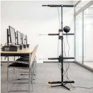
Resim 7: Tüm yükseklikler testo 400 kullanılarak ölçülebilir.
