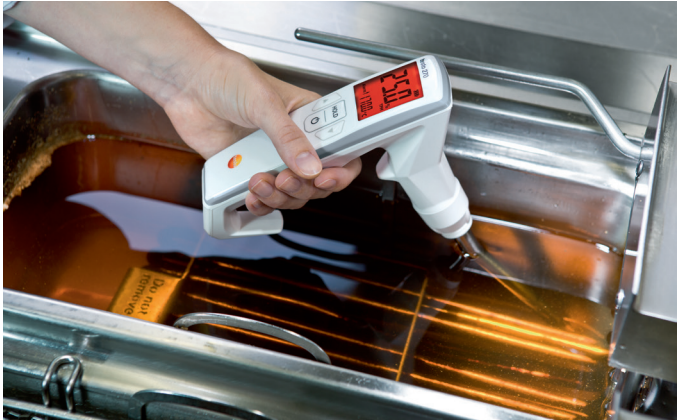
Şekil 10: testo 270 kullanarak kızartma yağdaki TPM değerinin ölçülmesi
