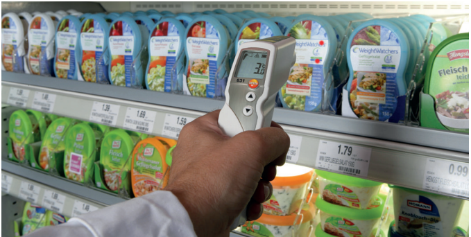
Şekil 5: Gıdalarda yüzey sıcaklığının kızılötesi ile ölçümü
