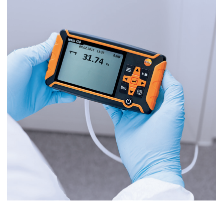
Bağlantı hortumu ile fark basınç ölçümü
