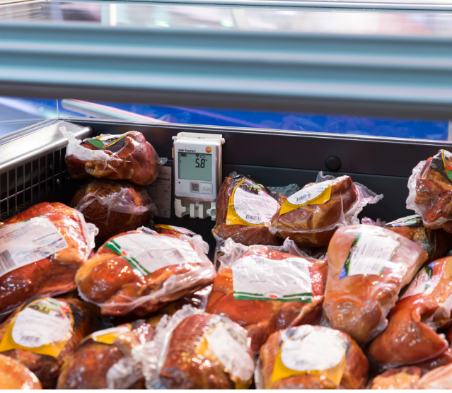
WiFi dataloggerları, bağımsız buzdolabı ekranlarının manuel belgelendirilmesini sağlar.
