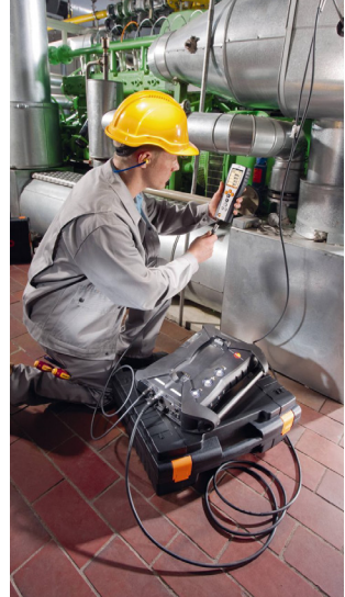
Şekil 43: testo 350 – endüstriyel emisyon ölçümü için baca gazı analizör sistemi
