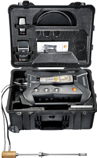
Şekil 44: testo 350 MARITIME – marin deniz motorları için baca gazı analizörü
